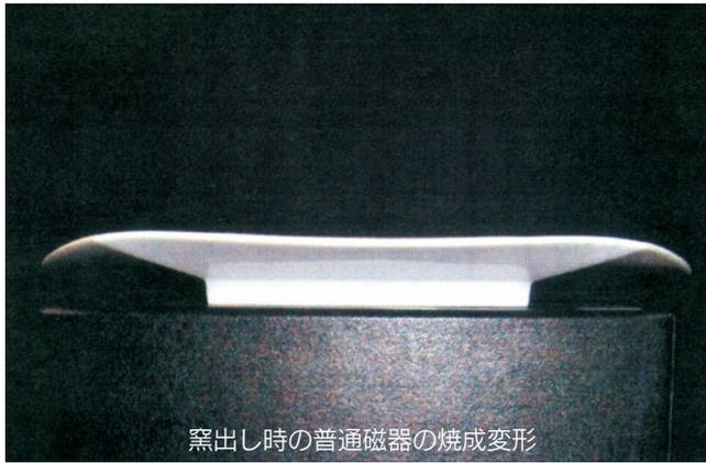
窯出し時の普通磁器の焼成変形
