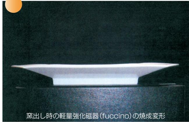
窯出し時の軽量強化磁器 (fuccino) の焼成変形
